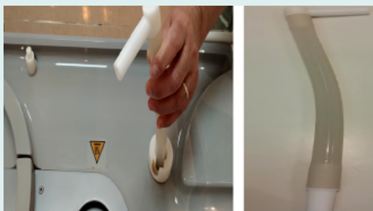
Figura 8. Desconexión del conector
