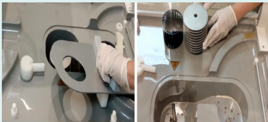
Figura 4. Cobertor del calefactor, disipador y turbina
